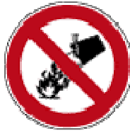
Verboden met water te blussen
